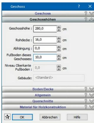
Sie passen im Register "Geschosshöhen" die Einstellungen für das Erdgeschöß lt. Bild an und bestätigen die Eingabe mit "OK".
