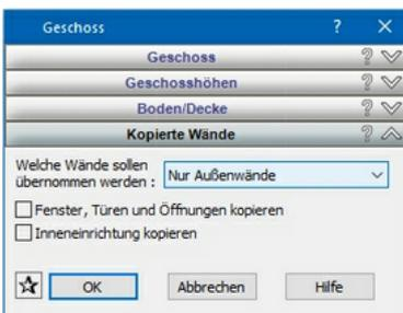
Für die Übernahme der Bauteile aus dem Erdgeschoß wählen Sie das Register "Kopierte Wände" und in der Auswahlliste "Nur Außenwände". (Dieses Register wird in einem leeren Projekt nicht angezeigt!)
